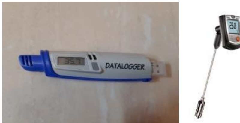
شکل ۳: به ترتیب از راست به چپ، دماسنج سطحی Testo 905-T2، دماسنج و رطوبت سنج Datalogger. (منبع: نگارندگان، ۱۴۰۰)
